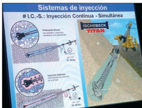
Carlos Arenas mostró en su exposición las etapas de la inyección continua-simultánea (ICS) con micropilotes Titan.
